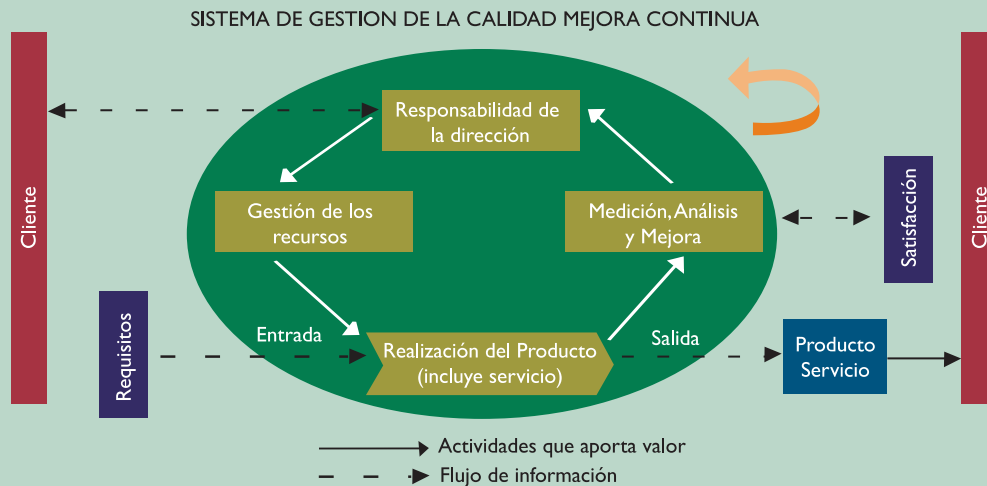
FIGURA A.5 EL SISTEMA DE GESTIÓN DE LA CALIDAD ISO-9001:2000 BASADO EN PROCESOS
